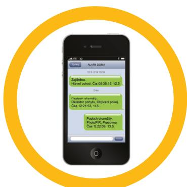
Texty povelů pro ovládání výstupů PG může nastavit montážní technik, např. ZALUZIE DOLU. Lze nastavit, že kód před povelom není vyžadován. V tom případě je uživatel identifikován podle telefonního čísla odesilatele SMS zprávy. Nastavení provede servisní technik.
