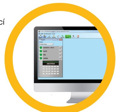
Systém je možné zajišťovat / odjišťovat pomocí ikon jednotlivých sekcí na spodní liště programu nebo tlačítka „Stav“ v záložce Sekce. Pokud je v systému použita klávesnice s alespoň jedním ovládacím segmentem, pak je možné zajišťovat / odjišťovat také pomocí stisku tlačítka segmentu na virtuální klávesnici (dostupná z Hlavního menu tlačítkem „Klávesnice“).
