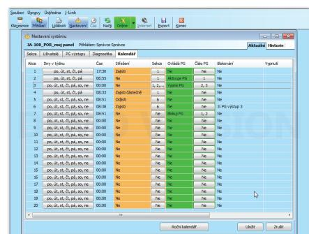
Zabezpečovací systém ukládá veškeré chování a všechny události (zajištění, odjištění, poplachy, poruchy, reportování uživatelům i pultu centrální ochrany) do paměti ústředny na micro SD kartu. U všech události je vždy uvedeno datum a čas vzniku nebo ukončení a zdroj události (příčina nebo původ).
