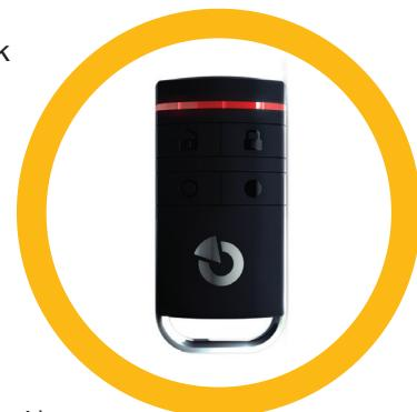
V případě nastavení systému na potvrzování při zajišťování s aktivní periferií (kap. 2.2.1), ovladač při požadavku na zajištění v případě aktivní periferie signalizuje nezajištění zelenou kontrolkou. Zajištění je nutné potvrdit dalším stiskem tlačítka zajištění. Zajištění sekce je poté potvrzeno červenou kontrolkou.
