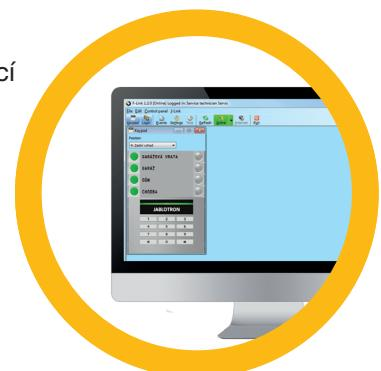
Systém je možné zajišťovat / odjišťovat pomocí ikon jednotlivých sekcí na spodní liště programu nebo tlačítky „Stav“ v záložce Sekce. Pokud je v systému použita klávesnice s alespoň jedním ovládacím segmentem, pak je možné zajišťovat / odjišťovat také pomocí stisku tlačítka segmentu na virtuální klávesnici (dostupná z Hlavního menu tlačítkem „Klávesnice“).
